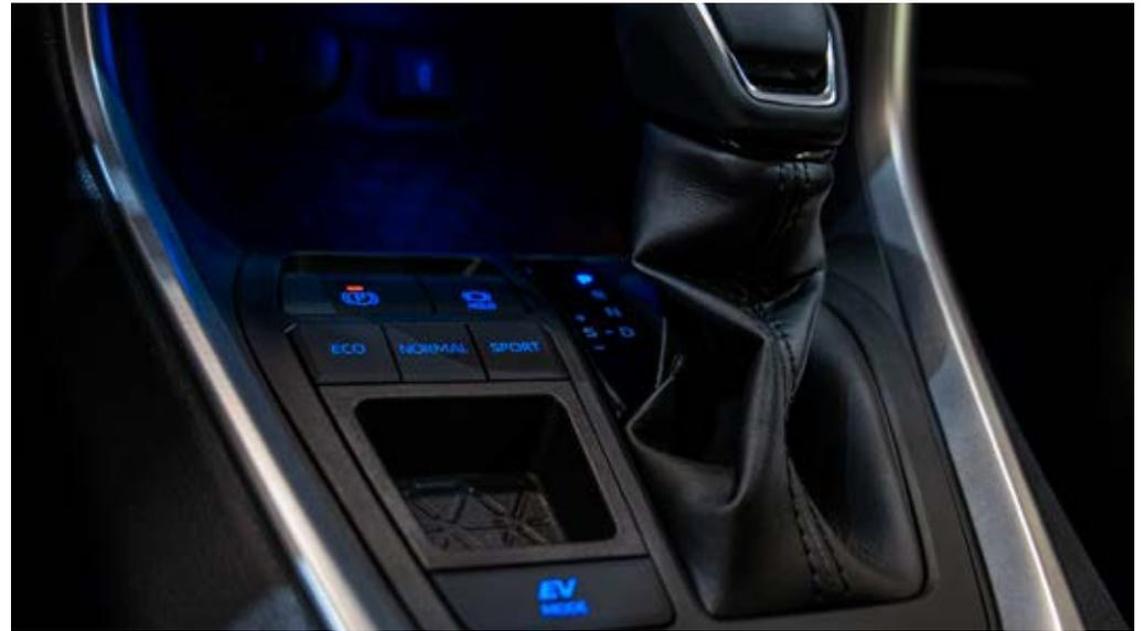
La RAV4 incorpora un tipo de transmisión automática eCVT, continuamente variable. Además, cuenta con 4 modos de conducción: **normal, ecológico, deportivo y eléctrico**, haciéndolo un vehículo versátil y preparado para cualquier tipo de conducción.
