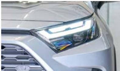
FAROS DELANTEROS BI-LED CON NIVELACIÓN AUTOMÁTICA EN ALTURA.
